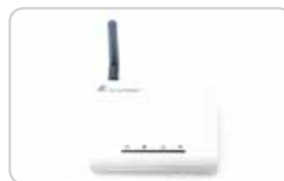
Centralka inteligentnego sterowania budynkiem
